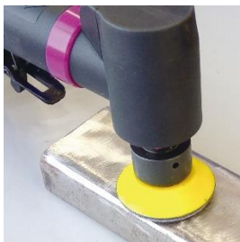
ジルコニア丸シート・ アルミナ丸シートにて 平面研磨やキズばかし
