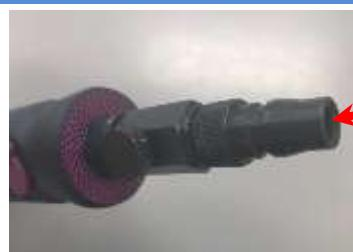
供給側カプラを外して、本機のカプラ内に1~2滴給油し、数秒空転させてください。
