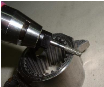
ダイヤモンドバーにて 金属製品のバリ取り・面取り
