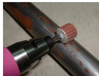
ワンタッチ軸付トップにて 狭い範囲のさび取り研磨
