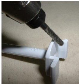
超硬カッターで樹脂製品の研削
