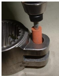
ゴム砥石にて穴部の内面仕上げ
