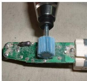
ナノフラップにて プリント基板のクリーニング
