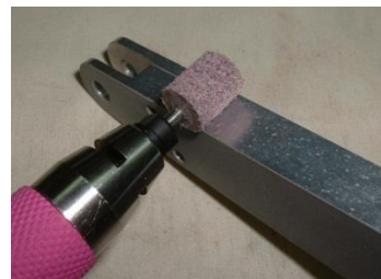
ユニロン軸付ハードにて 狭い範囲の研磨・クリーニング
